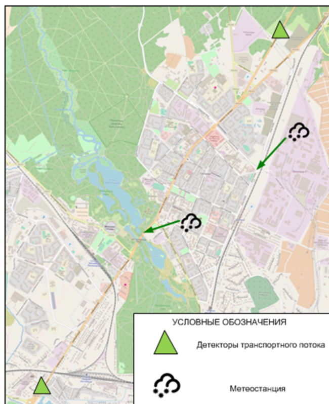
Рисунок 7 - Карта-схема расположения предлагаемых к установке детекторов транспортного потока и метеостанций.
